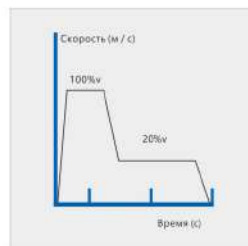
Концептуальная схема спецификации переменной частоты
