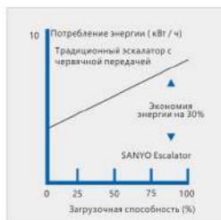
Концептуальная схема сравнения эффективности редуктора скорости с косозубой передачей и червячной передачей
